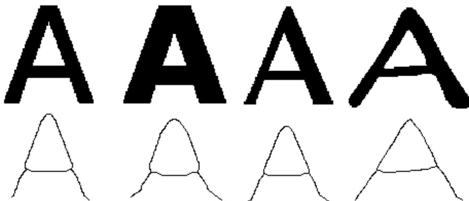
**Abbildung 2.4:** Skelettierungsalgorithmen bieten eine Datenreduktion und Abstraktion von Objekten. Hier wird der Buchstabe **A** in verschiedenen Strichstärken auf Ein-Pixel-Breite standardisiert, um eine optische Zeichenerkennung zu erleichtern [BILD 1].
